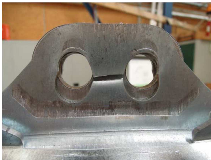
Figura 39: Rottura per block-tearing sui bulloni Ø16
